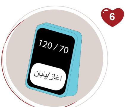
برای شروع تست، دکمه "START/STOP" (آغاز/پایان) را فشار دهید. در حین اندازه گیری، آرام بنشینید و حرف نزنید. حداقل دو بار به فاصله 1 دقیقه اندازه گیرید.\*
